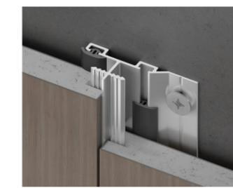
水缝压条效果示意图
